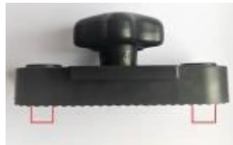
Dans les modèles (**Wollemi, Tongariro**), il est nécessaire d'ôter les ergots ovales de la partie inférieure de la cale en plastique et de déplacer la molette M8 dans la partie centrale par laquelle l'adaptateur « T » doit passer.
