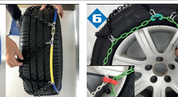
Fr - Basculer le câble flexible à l'intérieur de la roue en veillant à ce qu'il ne touche pas la bande de roulement.
