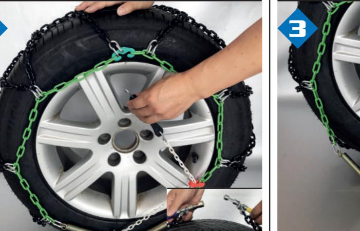
Fr - Décrocher le tendeur en caoutchouc noir et retirer la petite chaîne de mise en tension du maillon, puis du système autobloquant rouge.
