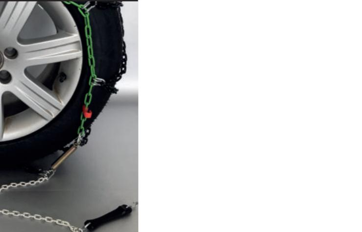
Fr - Décrocher le câble et laisser la chaîne tomber à même le sol. Déplacer un peu le véhicule pour dégager la chaîne. (Pour les voitures à traction avant, il est conseillé de braquer les roues pour décrocher plus facilement le câble intérieur)
