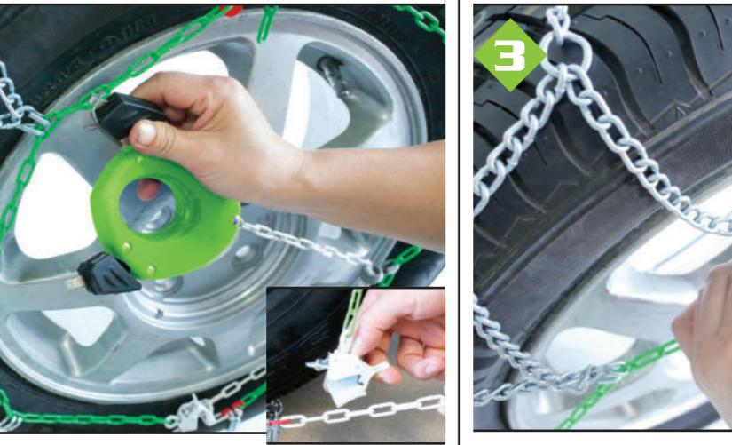
Fr - Décrocher le système de re-tension automatique TXR7 et retirer la chaîne de tension blanche du crochet plastique gris puis du système autobloquant blanc.
