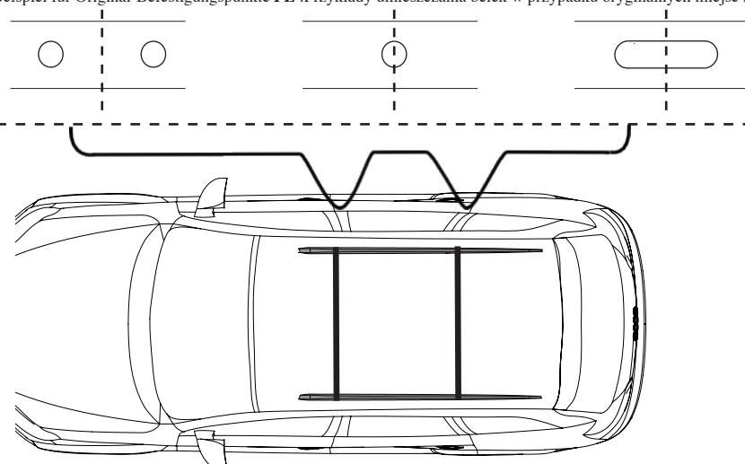
F : Si le véhicule est équipé avec points de fixation d'origine, placer les barres de toit en correspondance d'entre eux
