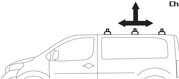
FR: Le serrage des dispositifs de fixation et des pièces de sécurité, des barres porte-charges de toit, ainsi que des accessoires ajoutés doivent être vérifiés après chaque chargement et régulièrement pendant le trajet.
